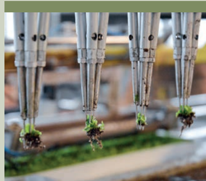
Automatisch verspenen van zaai bak naar tray Automatic transplanting from seedbox to tray
